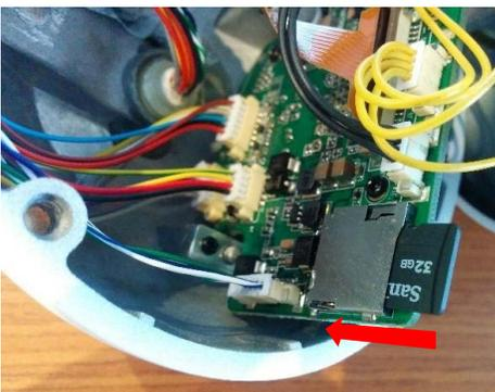
Insertar la tarjeta SD como se muestra en la imagen, y presionarla suavemente en la ranura hasta que esta haga un enclave o clic que indica que se ha sujetado correctamente. Para armar la cámara IP, realiza el procedimiento inverso llevado a cabo al desarmarla.
