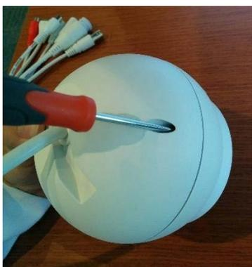
Remover primeramente la cubierta de soporte de la cámara y el anillo protector, para así tener acceso a los tornillos en la parte posterior del cuerpo de la cámara. Removerlos con destornillador de estría.
