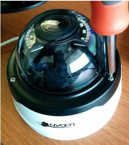
Remover primeramente los tornillos en la parte frontal del cuerpo de la cámara. Removerlos con destornillador estrellado, para liberar de esta manera la cubierta protectora de la cámara antivandálica.
