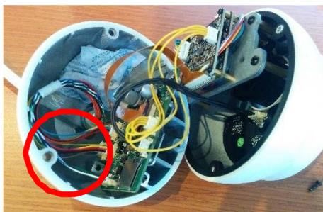
Abrir de manera cuidadosa el cuerpo de la cámara para acceder a la placa de circuito impreso en el interior de la cámara, donde podrá ubicar la ranura donde se inserta la tarjeta SD como se muestra en la imagen
