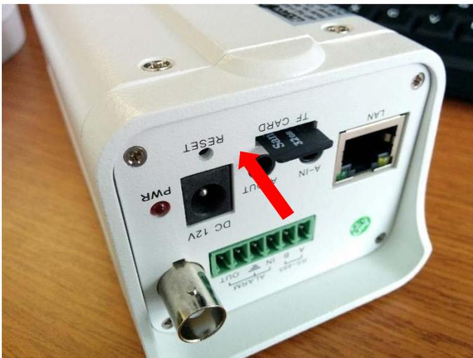
Insertar la tarjeta SD como se muestra en la imagen, y presionarla suavemente en la ranura hasta que esta haga un enclave o clic que indica que se ha sujetado correctamente.
