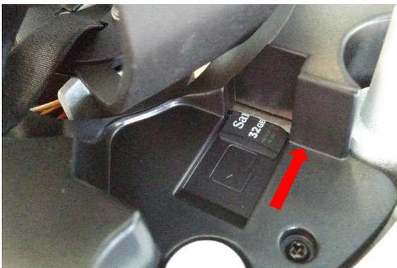
Insertar la tarjeta SD como se muestra en la imagen, y presionarla suavemente en la ranura hasta que esta haga un enclave o clic que indica que se ha sujetado correctamente.
