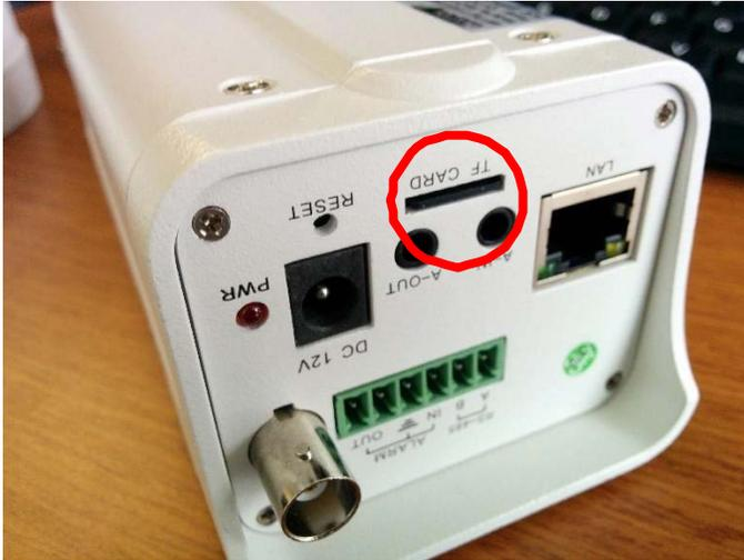
En la parte posterior del cuerpo de la cámara IP podrá ubicar la ranura donde se inserta la tarjeta SD como se muestra en la imagen.
